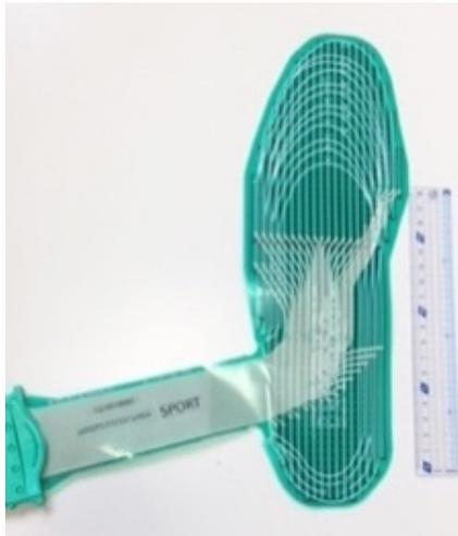
図 48 F-Scan 測定センサー
